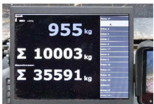
Abb. 28: Software/Display Kranverwiegung hellblau Gewicht im Greifer
