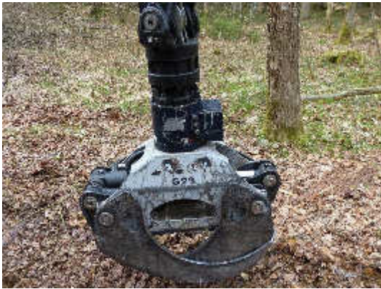
Abb. 33: Kranwaage über dem Greifer
