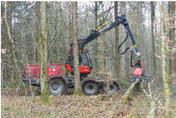
Abb. 21: Harvester bei der Aufarbeitung von Laubholz
