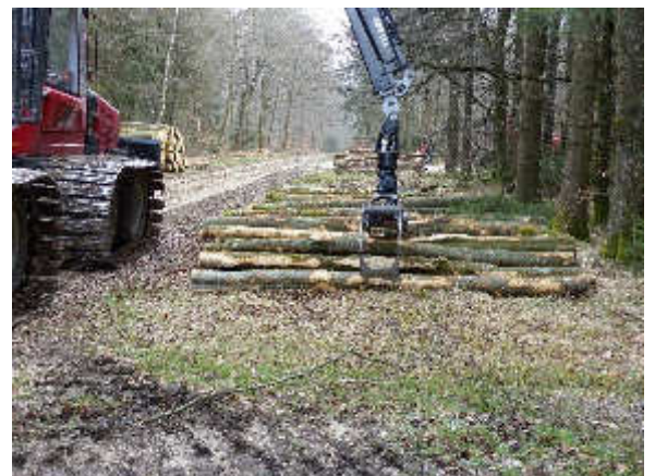
Abb. 24: Forwarder beim Polter zusammenstellen und verwiegen
