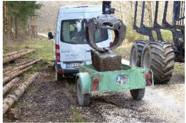
Abb. 32: Kontrollwiegung eines bekannten Gewichts
