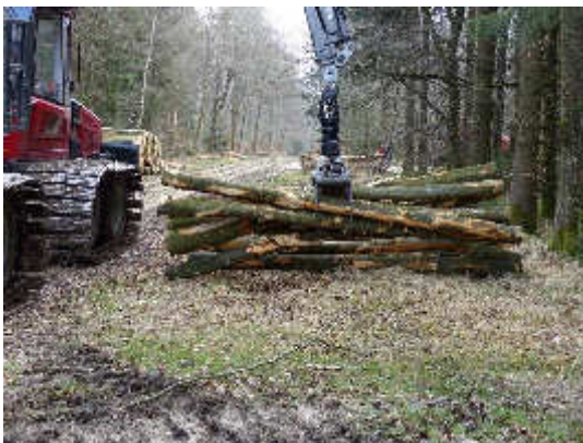
Abb. 29: Greifer über dem Polterplatz ist und abgesenkt werden muss
