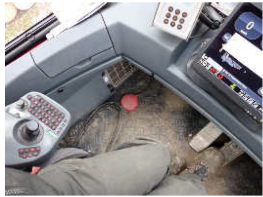
Abb. 30: Auslösen der Wiegung mit rotem Fußpedal wenn...
