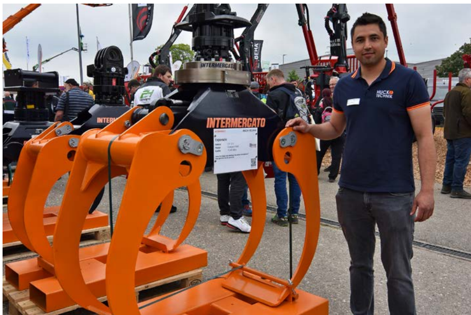
Roman Huck neben einem Holzgreifer der Serie „TG Ultra“, gefertigt aus dem hochfesten Konstruktionsstahl „Strenx 900“. Foto: Waid
