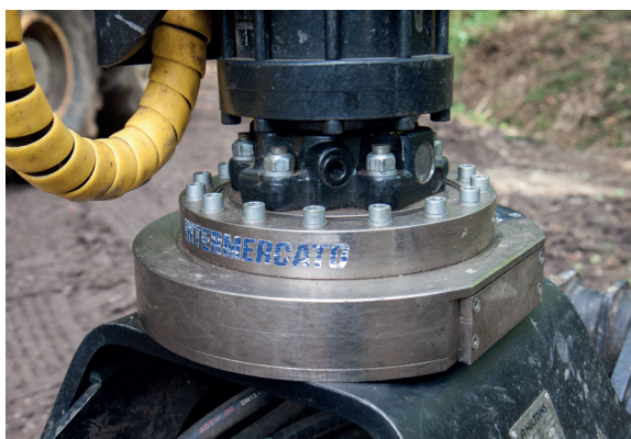
Die Kranwaage Compact FM ist 10,5 cm hoch und wiegt 65 kg
